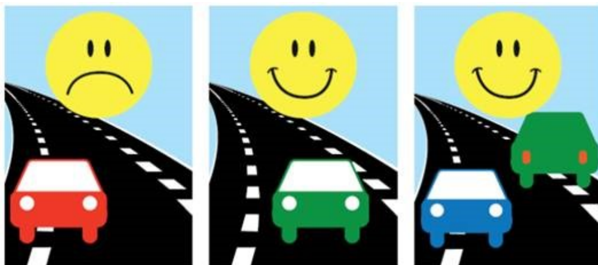
Figur 13 : En «2 minus 1 veg» er en veg som visuelt bare har et kjørefelt, men med trafikk i begge retninger. Begge sider av kjørefeltet er avgrenset av brede vegskuldre som er merket med stiplede og brede kantstriper. De brede vegskuldrene fungerer primært som ferdselsareal for myke trafikanter, men også som areal når motgående trafikk skal passere hverandre.
