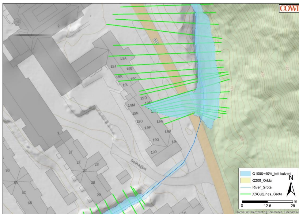
Figur 31: Figuren viser flommens utbredelse ved oppstuing av kulverten.
